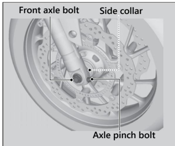
8. Loosen the left axle pinch bolt.
