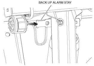
ASSEMBLED BACK UP BUZZER
