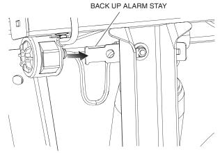
ASSEMBLED BACK UP BUZZER
